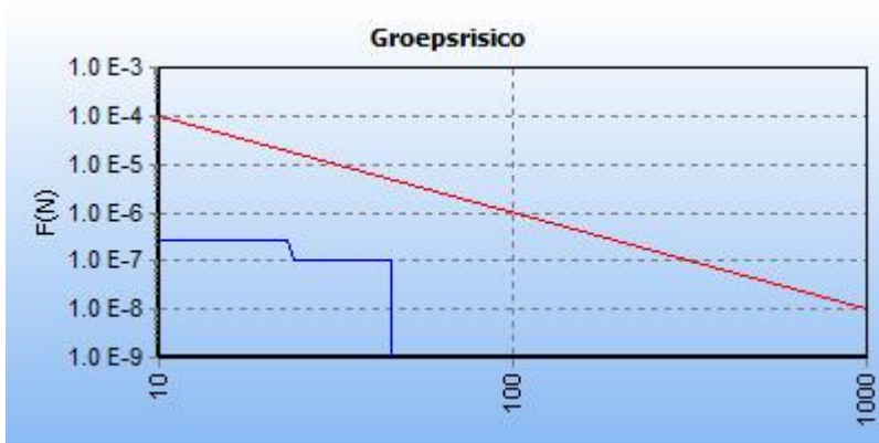
Figuur 5.1 FN curve voor 17-OLD1-10-S-5000 van Vermilion Oil & Gas Netherlands BV voor de kilometer tussen stationing 8480.00 en stationing 9480.00
