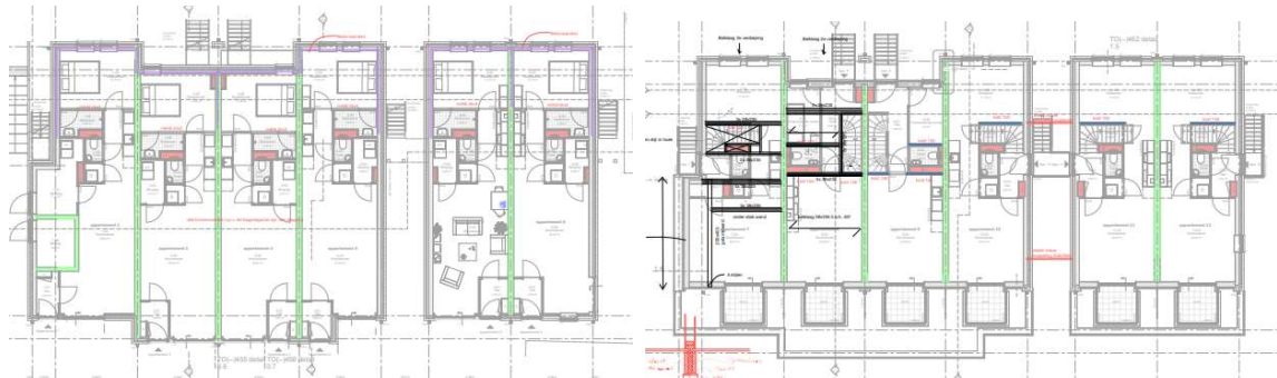
Sousterrain – grotendeels in kalkzandsteen gestapeld – deels in betonwanden langs de Middenweg
