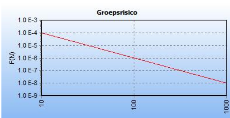
5.2 Figuur 5.2 FN curve nieuwe situatie voor 8451_leiding-A-541-deel-1 van N.V. Nederlandse Gasunie voor de kilometer tussen stationing 890.00 en stationing 1890.00
