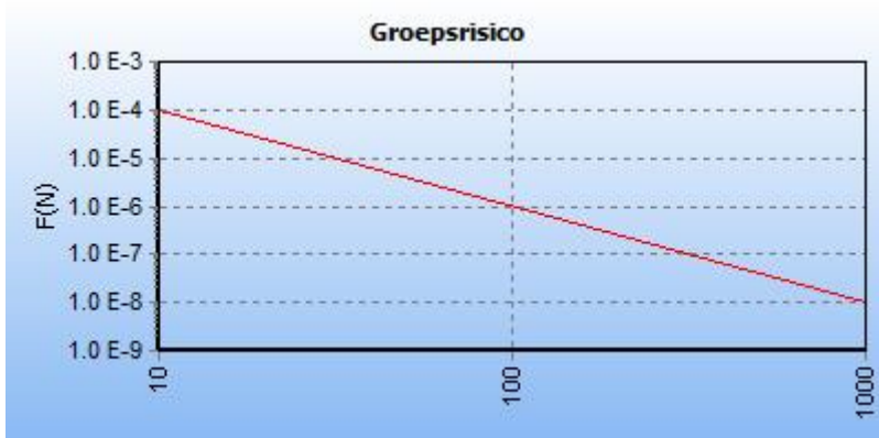
5.1 Figuur 5.1 FN curve bestaande situatie voor 8451_leiding-A-541-deel-1 van N.V. Nederlandse Gasunie voor de kilometer tussen stationing 890.00 en stationing 1890.00
