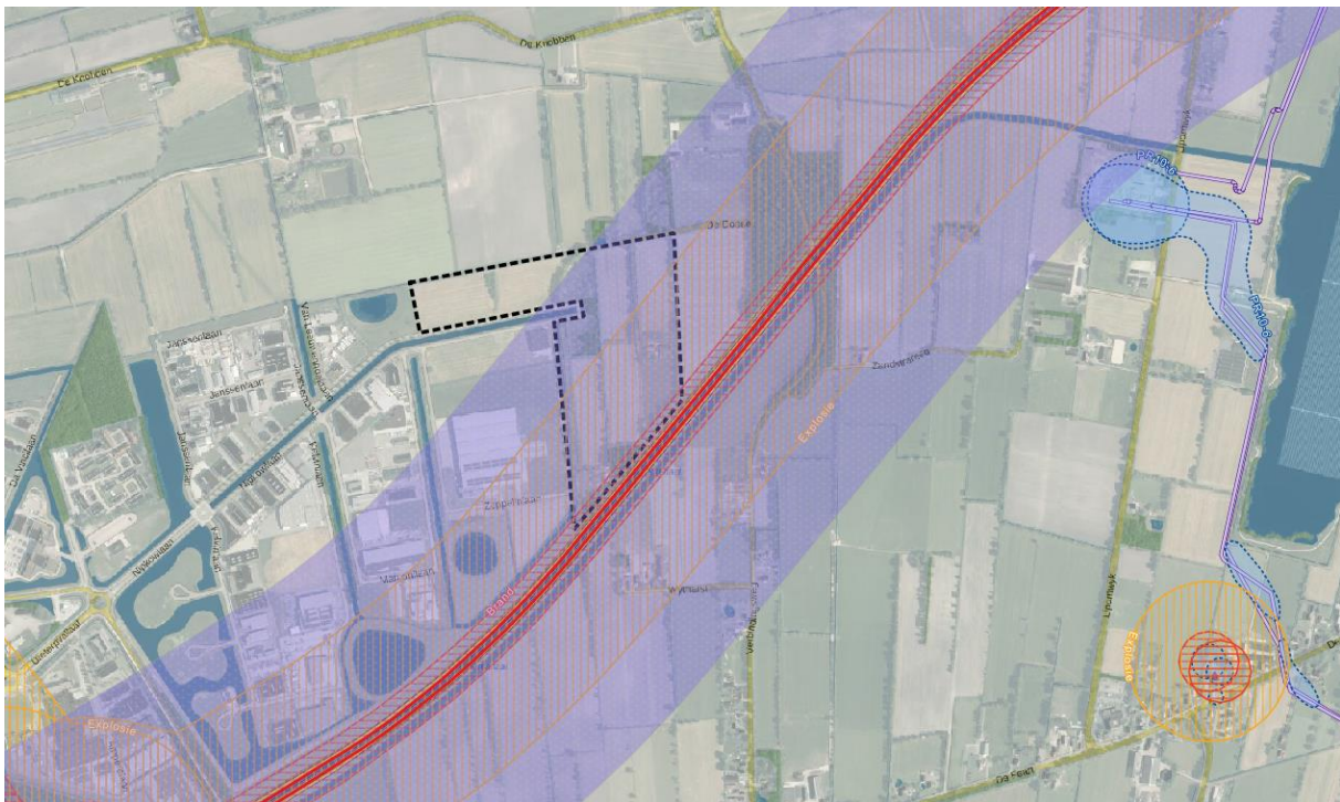
Figuur 3: Ligging plangebied t.o.v. de A7 met invloedsgebied (355 m) en toetsingsafstand (200 m).
