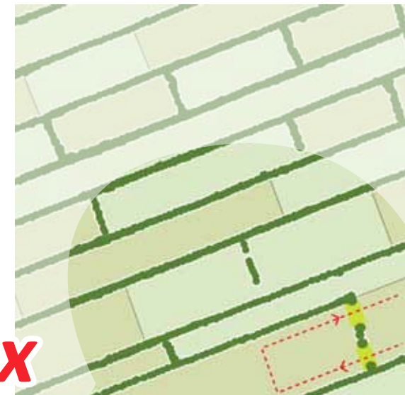
Meer dan een dam in de korte zijde van het perceel.
