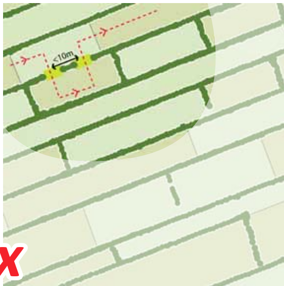
Onderlinge afstand tussen dammen minder dan 10 meter.
