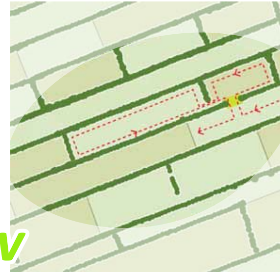
Een dam in de lange zijde van een perceel.
