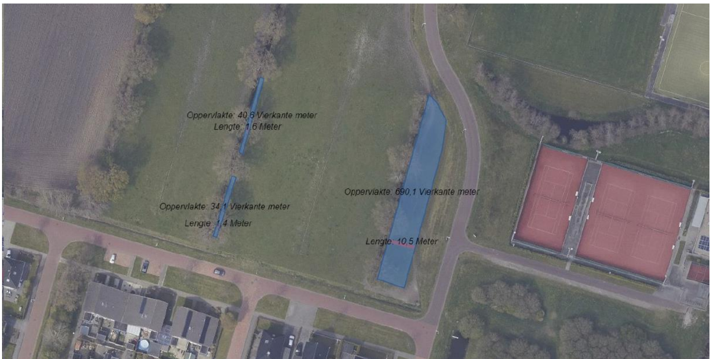
Figuur 3.1 Waterberging in het plangebied door verbreding bestaande sloten
