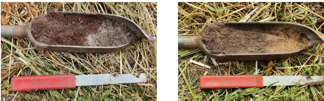
Figuur 9: Nij Beets, Geawei 2: Foto's van de boring 8. Links de overgang van het veen naar de grijze uitspoelingslaag of gewassen dekzand (tussen 45-55 cm -Mv). Rechts de overgang van deze grijze zandlaag naar het gele dekzand (C-horizont, tussen 65-75 cm -Mv). Het boormes heeft een lengte van 25 centimeter.
