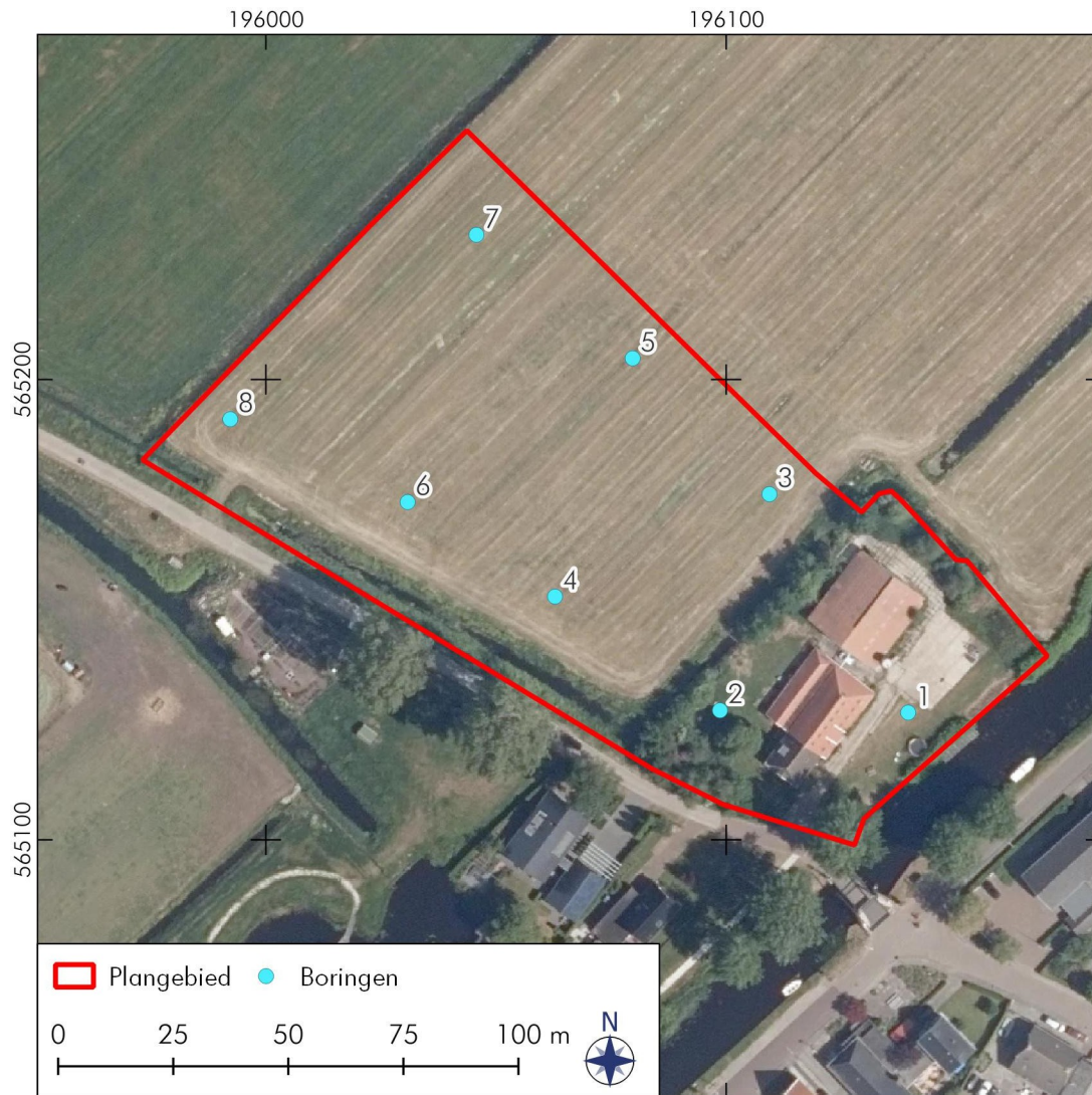
Figuur 8: Nij Beets, Geawei 2: Locatie van de boringen. Boringen 1 en 2 lagen rondom de boerderij. Boringen 3 tot en met 8 lagen in de lager gelegen akker.
