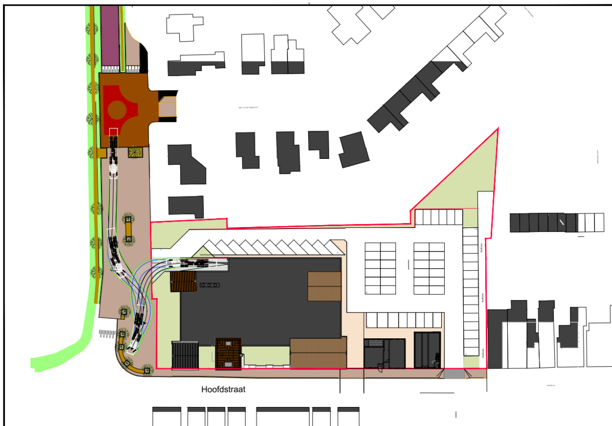
Figuur 7: Ontwerp met rijcurven truck met oplegger, achterwaarts inrijdend
