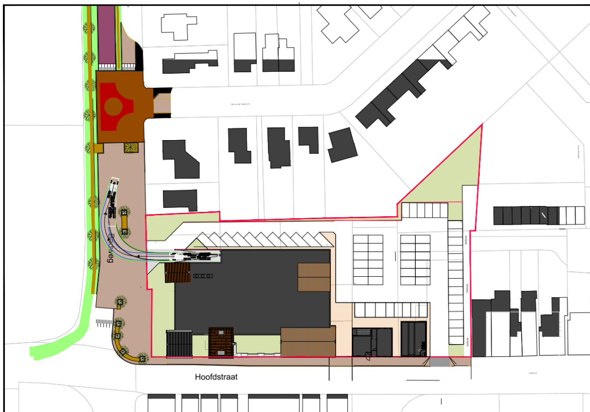
Figuur 8: Ontwerp met rijcurven truck met oplegger, vooruit wegrijdend
