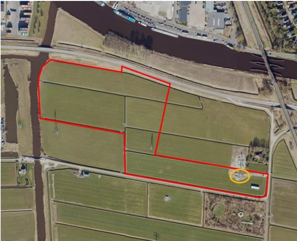
Figuur 4 Het projectgebied (aangegeven in rood) en de locatie van de hoogspanningsmast LSM-RWD-110-27 (aangegeven in geel) waarbij een opstijgpunt wordt aangelegd
