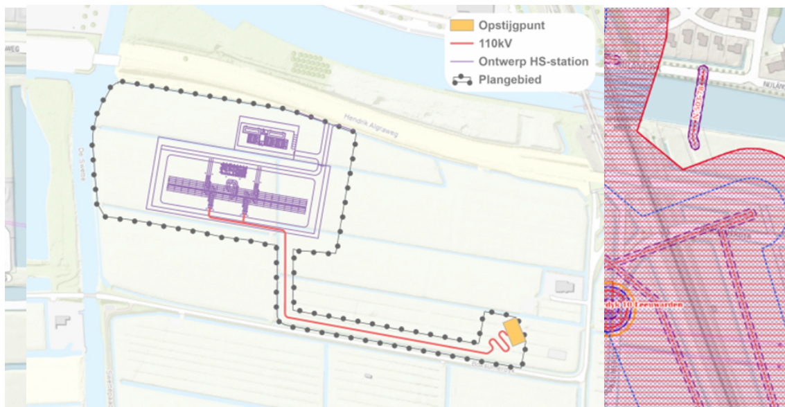
Figuur 1: Plangebied nieuwe 110/20kV-station Leeuwarden Zuidwest gelegd over de contouren in de Signaleringskaart EV. De werkelijke ligging van het hoogspanningsstation t.o.v. de hogedruk aardgasleidingen kan enigszins afwijken.
