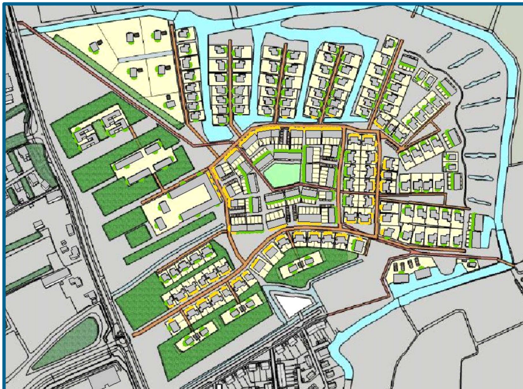
Afbeelding 4.1: Geluidbelasting per onderzochte gevel. Bij een groene kleur wordt de voorkeursgrenswaarde van 48 dB niet overschreden. Bij een oranje kleur vindt een overschrijding van de voorkeursgrenswaarde plaats
