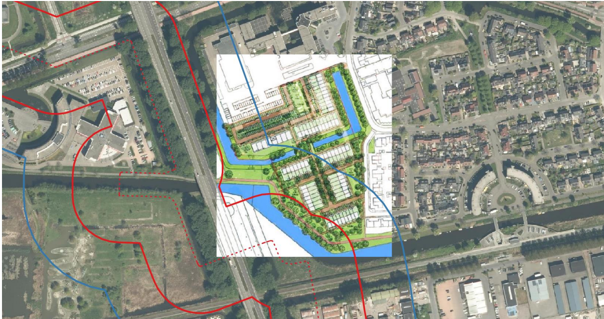
Figuur 6. Buisleiding (rode onderbroken lijn), grens invloedsgebied 1% letaal (blauwe lijn) en grens 100% letaliteitszone (rode lijn).
