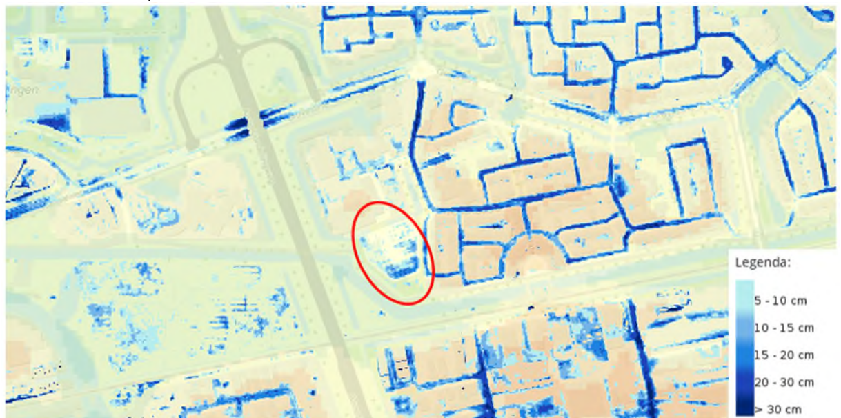
Figuur 2-11 Waterdiepte bij hevige bui van 70 mm / 2 uur (plangebied rood omkaderd) (bron: klimaateffectatlas)
