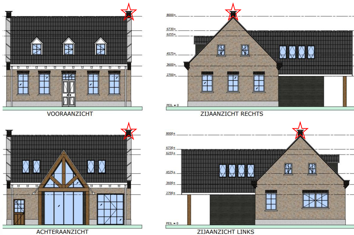
Figuur 1. Locaties (rode ster) van de in te metselen vleermuiskasten in beide schoorstenen.
