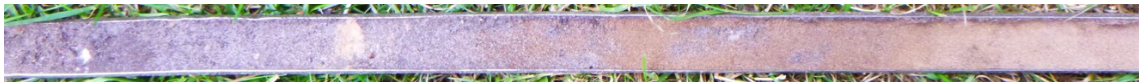
Figuur 6: Oudehorne, Tweede Sluisweg 35: Boring 2 met links de rommelige toplaag van overwegend humusrijk zand, in het midden de BC-horizont van geoxideerd zand en rechts het lichtgele zand van de C-horizont.
