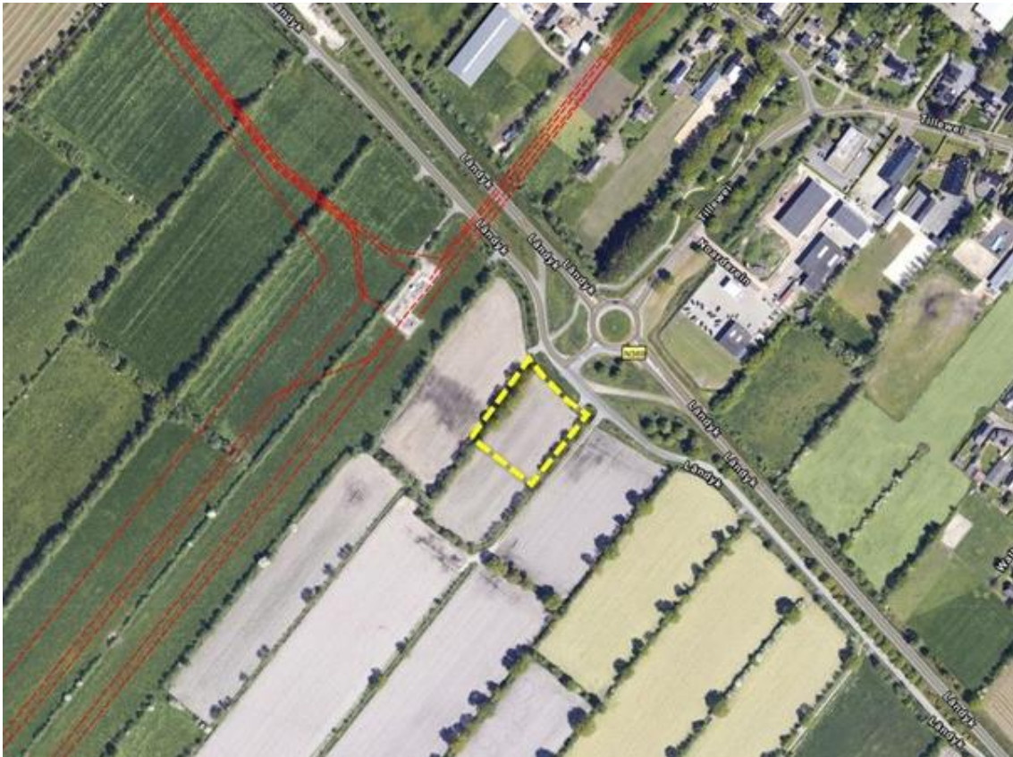
afbeelding 11: uitsnede risicokaart, de rode lijnen zijn de aardgasleidingen, de projectlocatie is met een gele stippellijn aangeduid (bron: www.risicokaart.nl )
