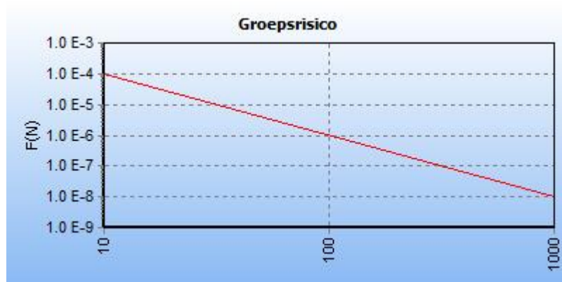
Figuur 5.1 FN curve voor 9070_leiding-N-505-60-deel-1 van N.V. Nederlandse Gasunie voor de kilometer tussen stationing 640.00 en stationing 1640.00
