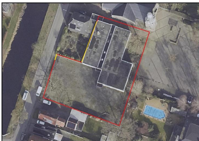
Figuur 6.5: De plaatsing van het amfibieënscherm aangegeven door de gele omlijning
