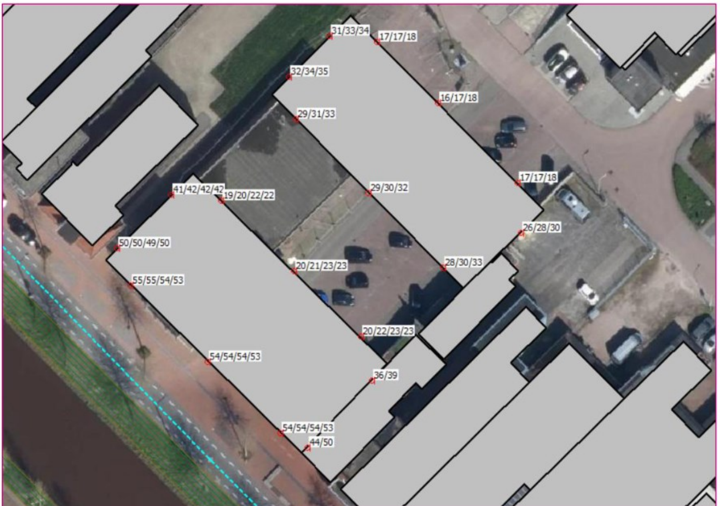
Afbeelding 4: Geluidbelastingen op de gevel
