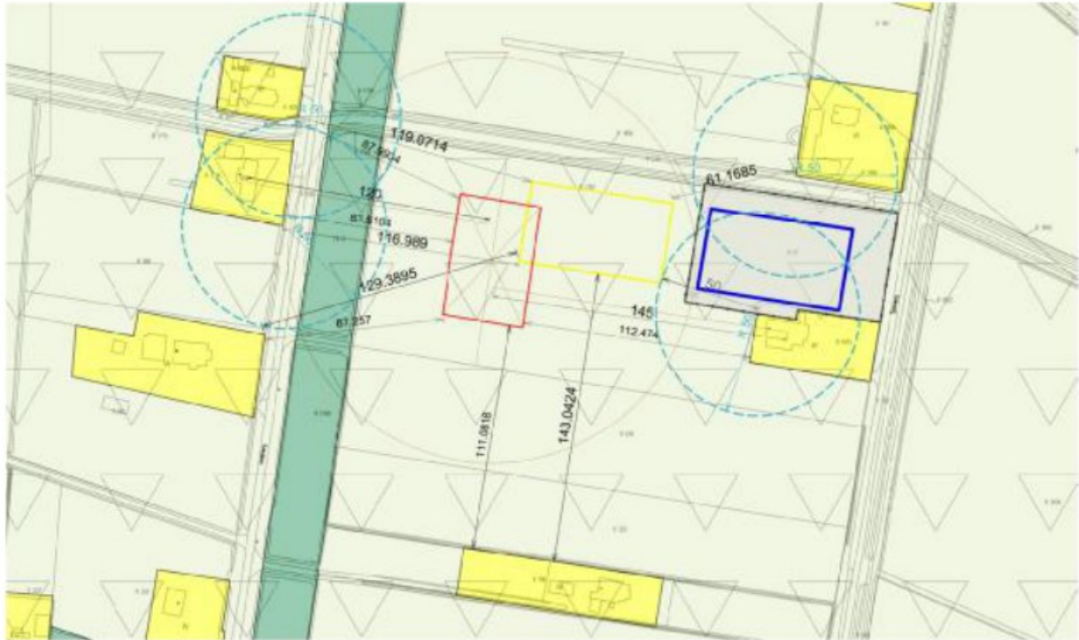
Figuur 3: Studie gemeente Stadskanaal inzake situering nieuw woonperceel waarbij het gele vlak als uitgangspunt is gekozen.
