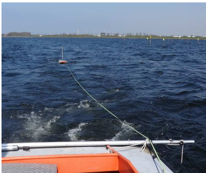
Figuur 3. Sleepopstelling van de magnetometer.
