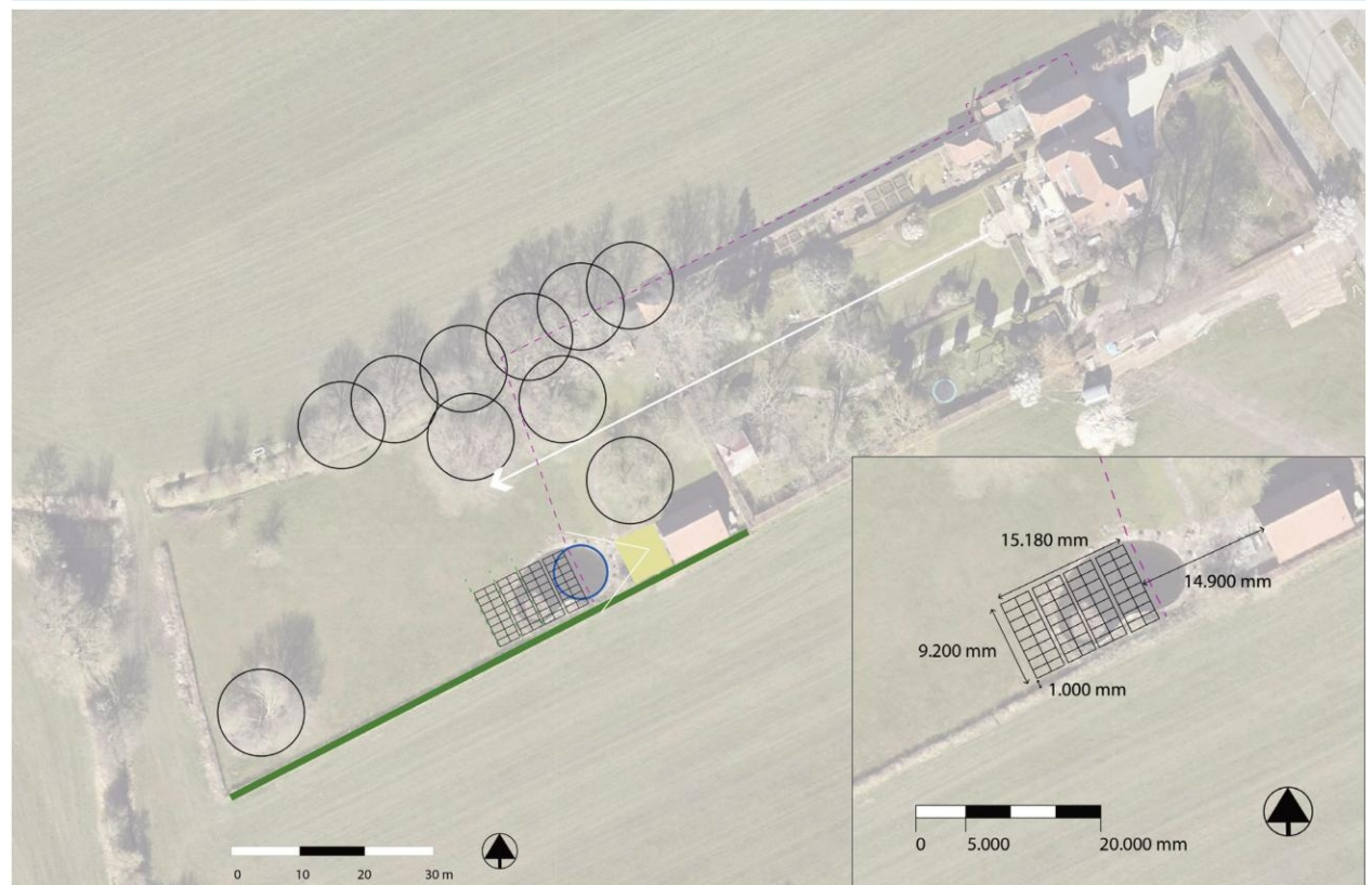
ligging en maatvoering paneelopstelling met aanduiding kabeltracé als paars gestippelde lijn
