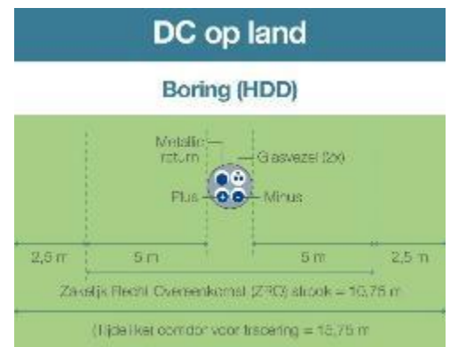
Figuur 2.9. Kabelconfiguratie boring
