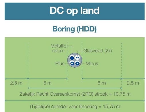
Figuur 2.9. Kabelconfiguratie boring
