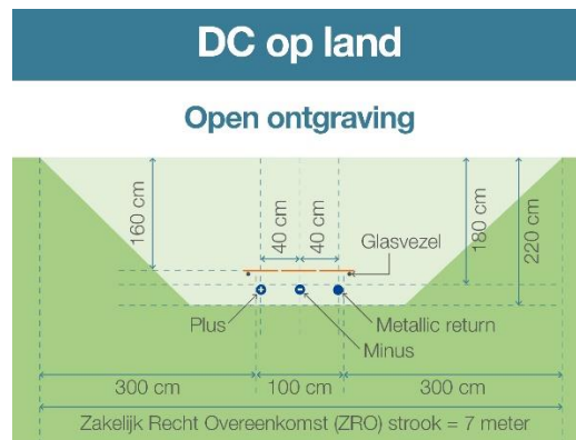
Figuur 2.8. Sleuf bij open ontgraving
