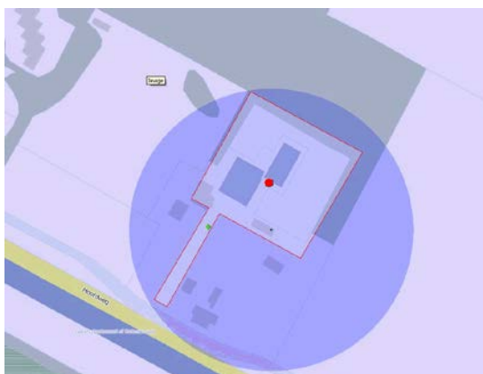
Figuur 5.7 : Zwembad Veen huizen met opslag van chloorbleekloog. Geen 10^{-6} risicocontour, wel 1%-letaliteit van 84 meter.
