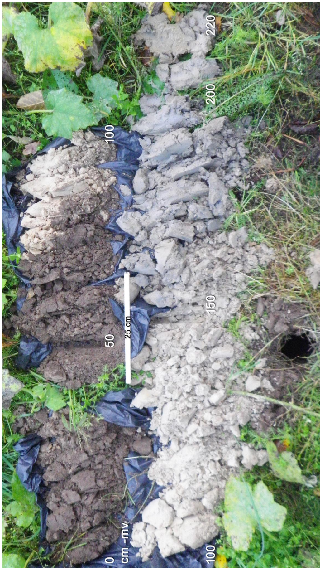
Figuur 2.3. De uitgelegde boring 8. De schaalbalk is 25 cm lang. De bodem is hier niet intact.
