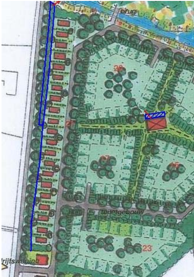
Figuur 4 Situering infiltratievoorzieningen en noodoverloop
