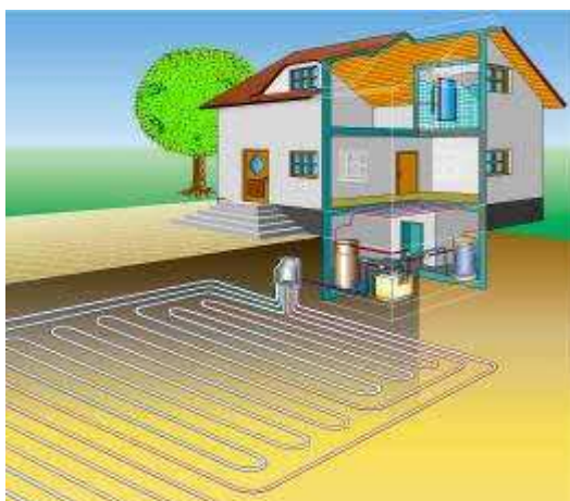
principe warmtepomp met bodem als bron
