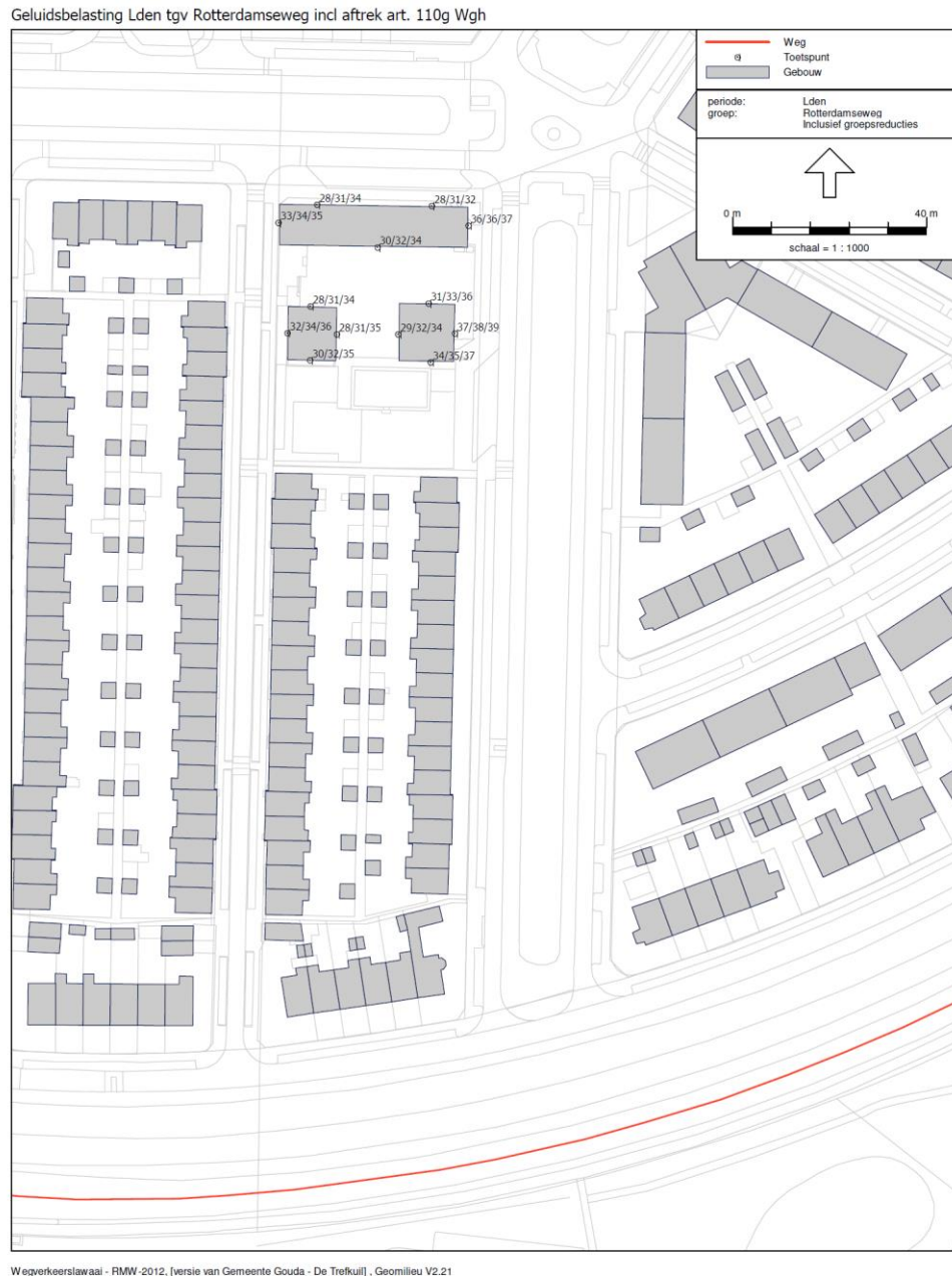
Figuur 2-1: Geluidsbelasting ten gevolge van de Rotterdamseweg 1,5/5/7,5m incl. aftrek art. 110g Wgh
