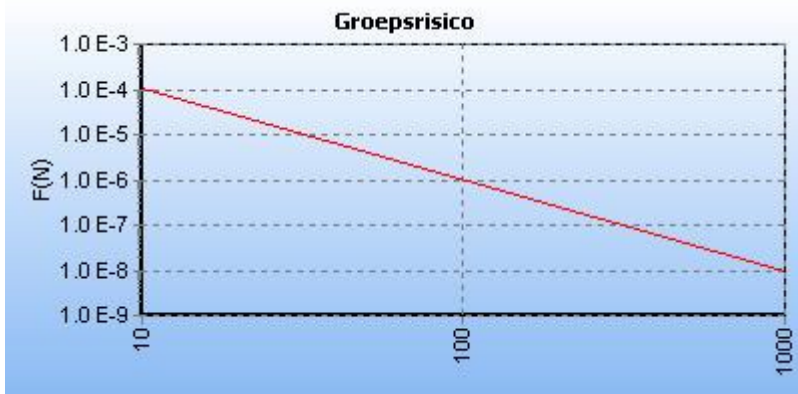
Figuur 5.3 FN curve voor W-529-15 van N.V. Nederlandse Gasunie voor de kilometer tussen stationing 0.00 en stationing 550.00
