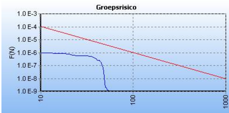
Figuur 5.2 FN curve voor W-529-04 van N.V. Nederlandse Gasunie voor de kilometer tussen stationing 0.00 en stationing 250.00
