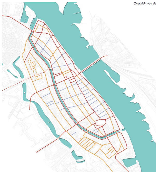
Wegenstructuur binnenstad met wegen van het primaire (rood), secundaire (geel) en tertiaire (blauw) niveau (Flexus, 2011).
